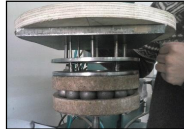
Figura 2: Sistema principal de desgaste
