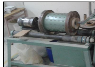
Figura 4: Soporte estructural de acero con rodillos
