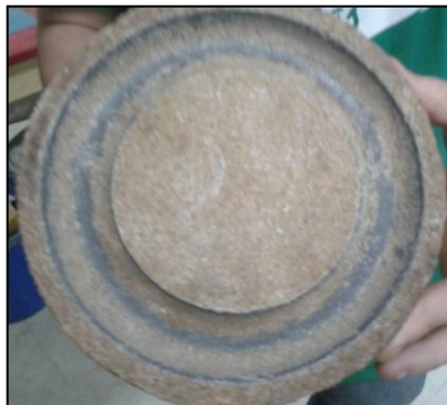
Figura 12 Resultados desgaste abrasivo de bolas en dispositivo
