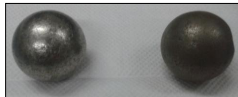
Figura 11 Comparación estado superficial de las bolas antes y después del experimento, a la izquierda bola desgastada, a la derecha bola en estado original
