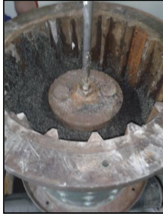
Figura 5: Metodología de llenado y montaje del contenedor
